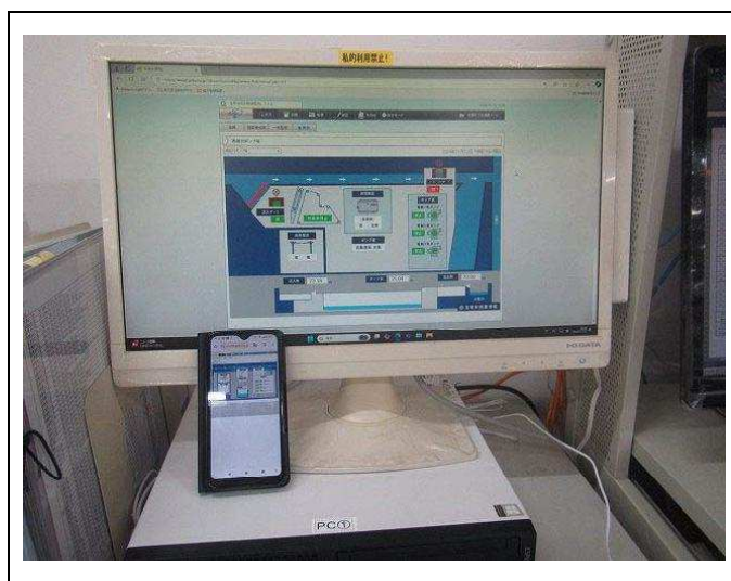
図 3-2-6 クラウド化した監視システム
