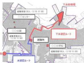
上下水道管路の一体的な耐震化のイメージ
