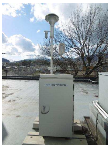
【図14】微小粒子状物質（PM2.5）測定機
