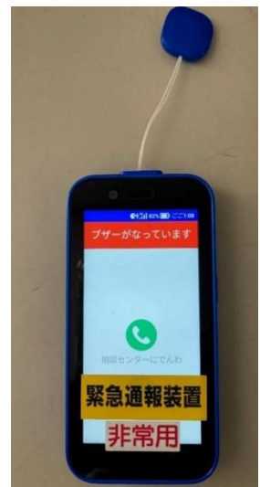
※携帯型緊急通報装置 サイズ：約 52×105×15mm
