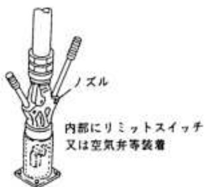
図 4-2-2 ノズル格納装置による誤発進を防止する方法
