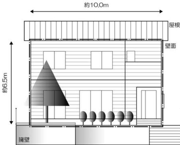
$$\text{緑視率 (\%)} = \frac{\text{樹木等の立面投影面積}}{\text{建築物の立面投影面積}} \times 100$$
